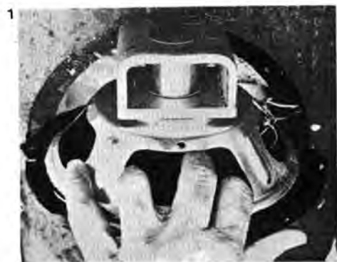
2 Τὸ ποτενοϊόμετρο σὶδὸ πίσω μέρος τῶν ἡχείων δίνει τὴ δυνατότητα ἀποκοπῆς ἢ ἐνισχύσεως τῶν μπάσων κατὰ 6dB.
